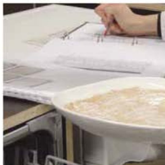
Příprava nádobí: pracovníci laboratoře štětcem nanášejí přesně definované množství nečistot.
